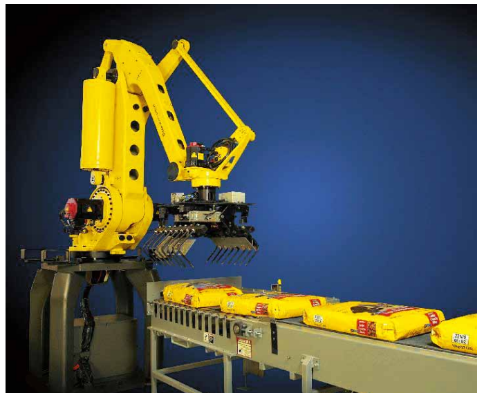
袋装物品的码垛堆积系统
