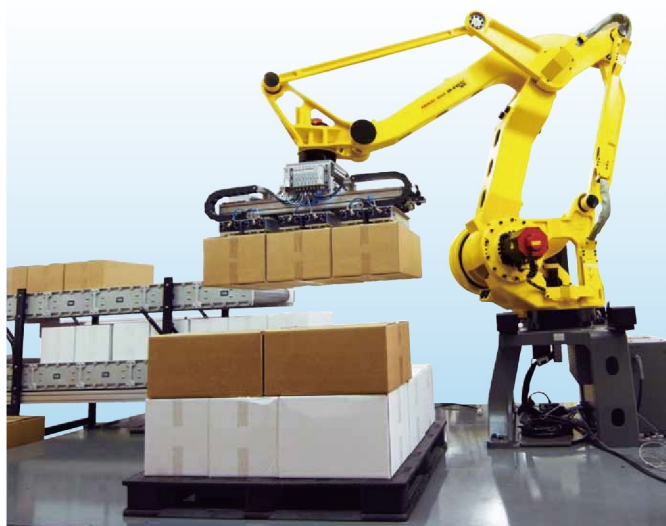
瓦楞纸箱的码垛堆积系统
